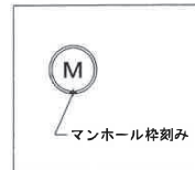
引照点詳細図 (M1, M2)
